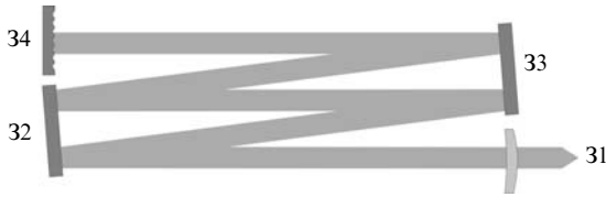
Рис.5. Схема резонатора технологического CO 2 -лазера: 31 – выходное зеркало из селенида цинка, радиус кривизны R = 30 м; 32, 33 – поворотные плоские зеркала; 34 – поляризационно-селективный элемент (дифракционное зеркало или аксикон).
